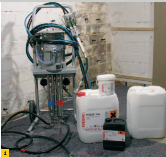
FOT. 1. Typowe stanowisko do wykonywania iniekcji kurtynowej. Wykorzystuje się do tego celu pompę dwuskładnikową.
